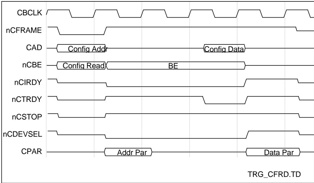
**FIGURE 12 - CardBus - TYPICAL CONFIGURATION READ/EPIC/C IS TARGET**
