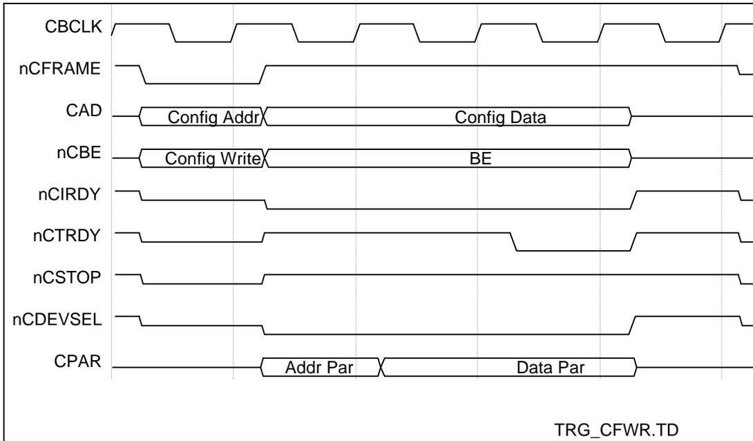
**FIGURE 11 - CardBus - TYPICAL CONFIGURATION WRITE/EPIC/C IS TARGET**
